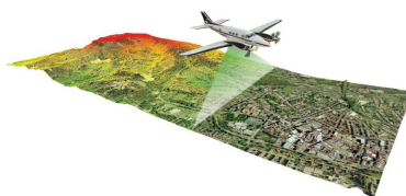
Obr.1: Letecké laserové skenovanie (zdroj: http://www.highwaysindustry.com )
