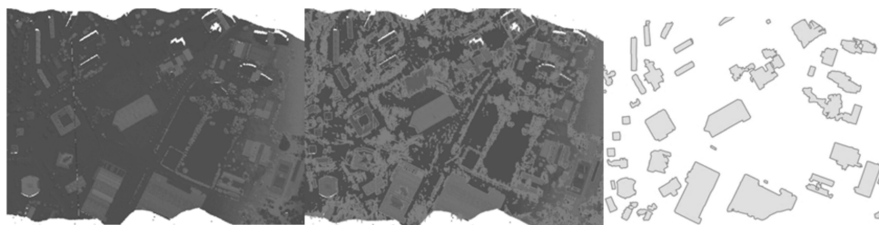
Obr. 11. Príklad automatizovanej detekcie hrán budov na základe údajov z mračna bodov
