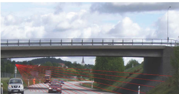
Obrázok 3 – 3D laserový skener použitý na zaznamenanie povrchu vozovky bez nutnosti prerušenia premávky [2]
