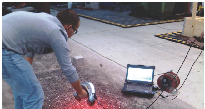
Obrázok 5 – Meranie Zscannerom na pokusnom poli
