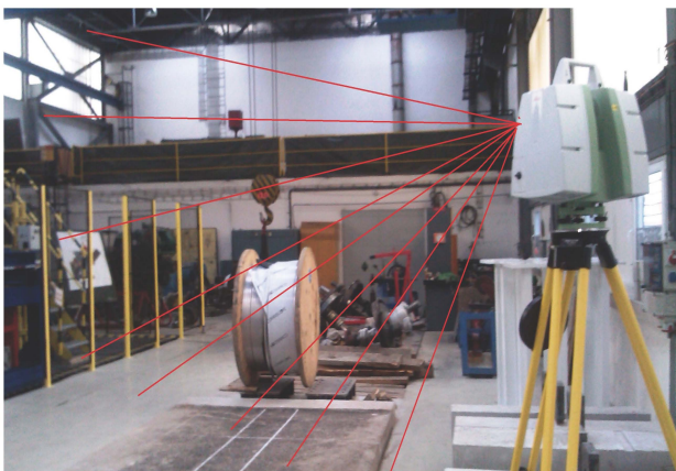
Obrázok 2 – 3D laserový skener a princíp merania na pokusnom poli
