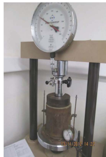
Obr. 3. Zariadenie pre meranie CBR
