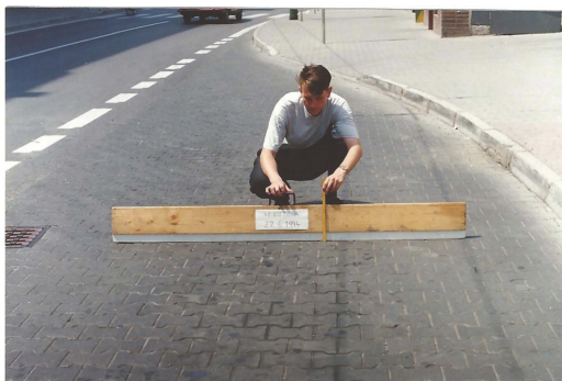
Obrázok 8 – Priečný profil č. 2 zastávkového pruhu dňa 27.8.1994 po prejazde 160 000 návrhových náprav
