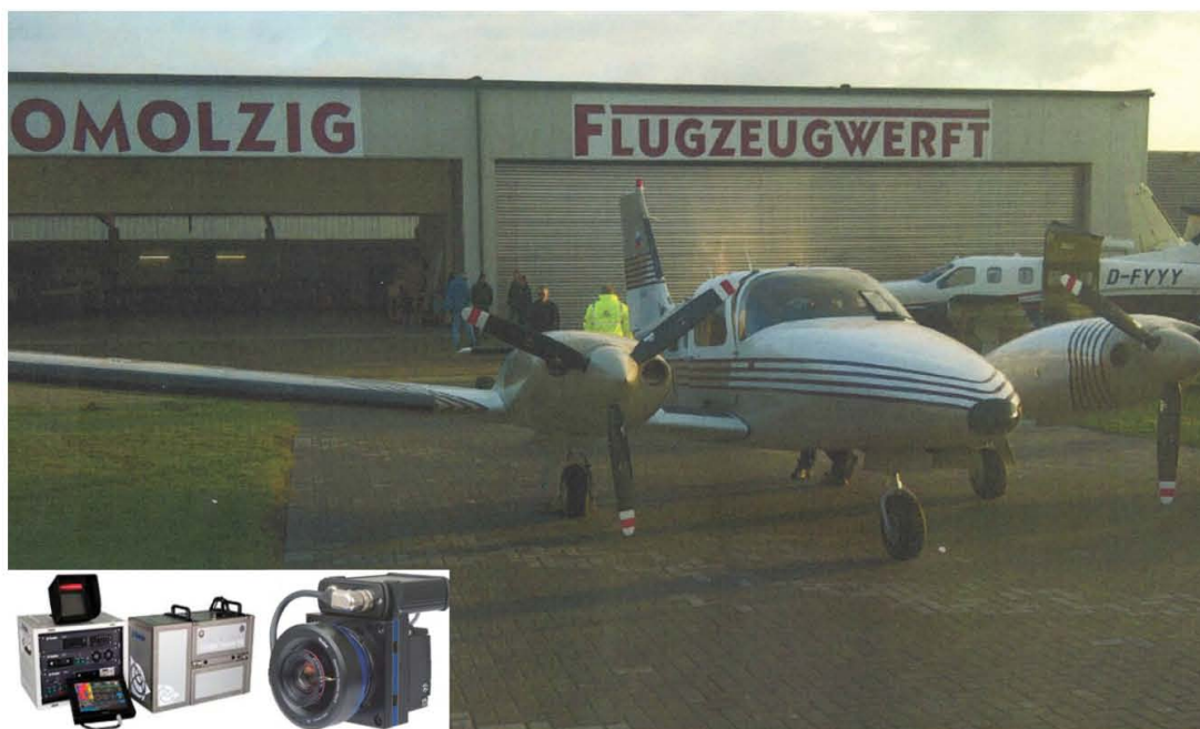
Obrázok 1: Lietadlo BCLD vybavené laserovým skenerom (LiDAR) a digitálnom kamerou
