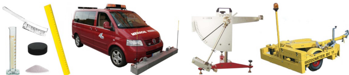
Obr.2. Použité zariadenia a pomôcky: 1) balotina – odmerná metóda - MTD , 2) Profilograph GE – MPD , 3) kyvadlo – PTV , 4) Skiddometer BV11 – Mu
