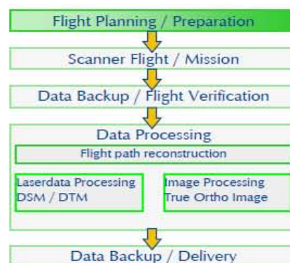
Obrázok 1 – Bloková schéma procesu leteckej fotogrametrie a laserového skenovania. [4]
